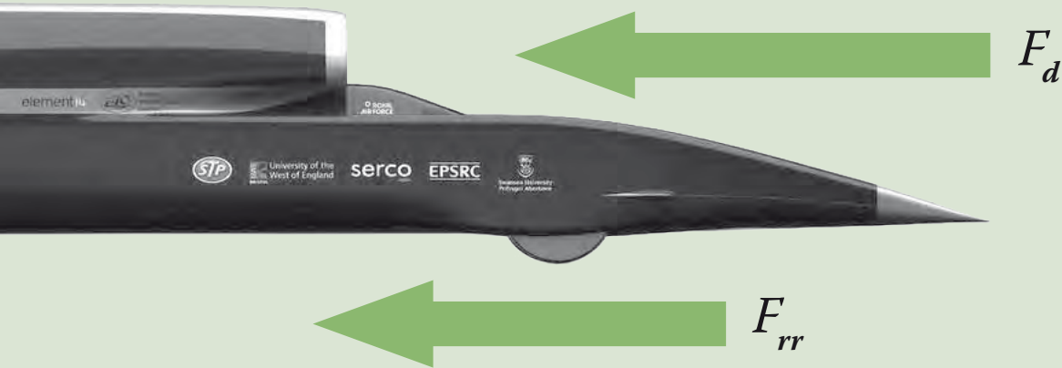
Figura 12. Diagrama de las fuerzas actuando sobre el Bloodhound ssc.
