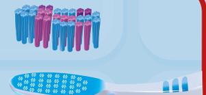
Para terminar, se utiliza una máquina de insertado automático que coloca veinte cerdas por orificio, esto da una suma de más de mil cerdas por cepillo! Éstas son ancladas utilizando presión y un alambre interior que asegura cada cerda para que no se desprenda.
