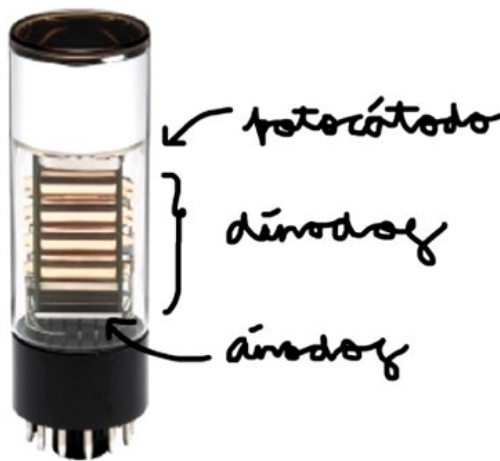
Imagen 2. Tubo fotomultiplicador y sus componentes. Tomado de: https://www.industry-plaza.com/amplifier-unit-c5594-p89465653.html
